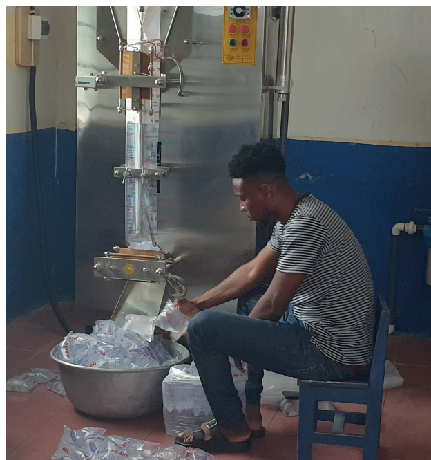
La première machine de conditionnement d'eau en service.
