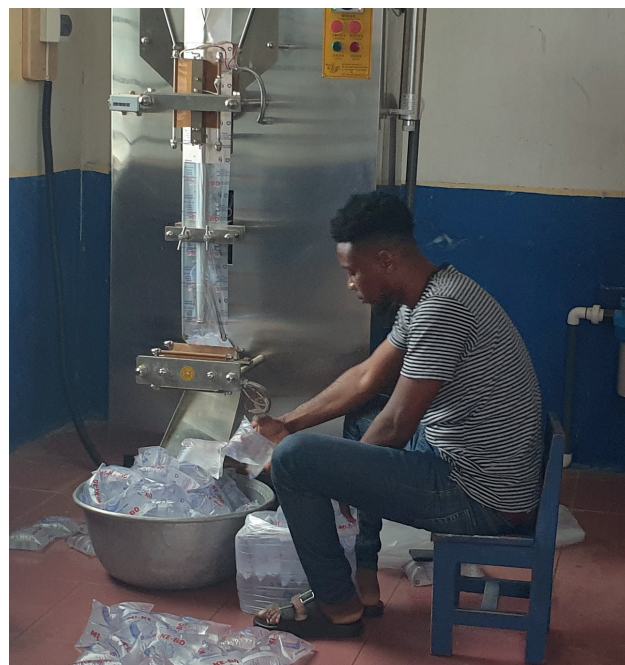
Een eerste water verpakkingsmachine in werking.
