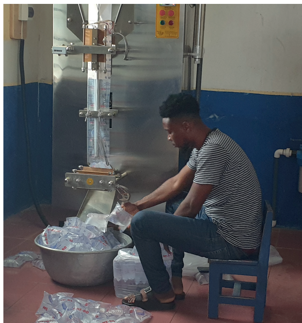
Een eerste water verpakkingsmachine in werking.
